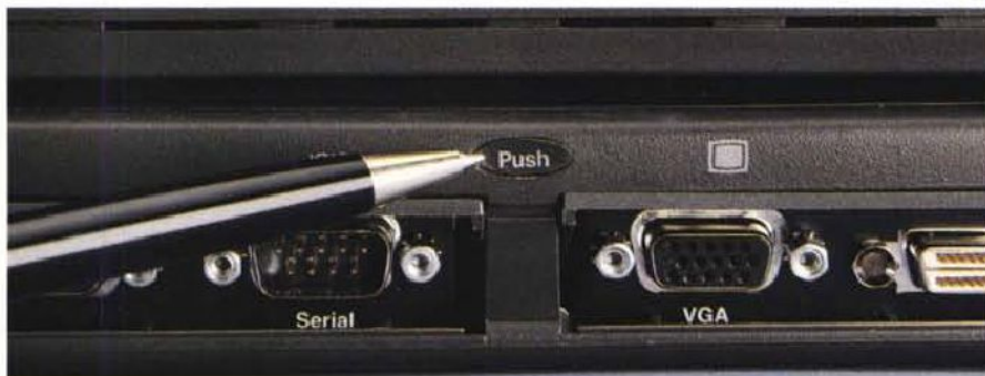
La novità è che l'apertura degli sportellotti è comandata meccanicamente da un pulsante così di evitare rotture o perdite degli stessi.
